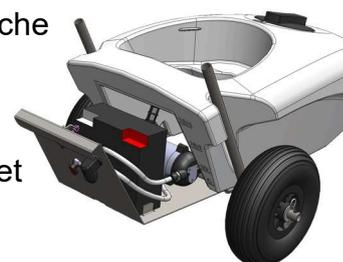
**Chargeur de batterie :** Le chargeur est livré avec la **MODULA G4** se connecte à l'arrière en lieu et place du cordon de guidon et fonctionne sur secteur 220 V. La durée de charge pour une batterie complètement vide est  $\approx$  6 heures. Le chargeur de batterie est équipé d'un témoin lumineux indiquant l'état de charge et d'un « delta peak » qui permet en fin de charge de maintenir un entretien de la batterie en attendant la déconnection.
