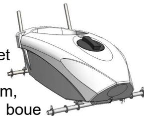
**Guidon :** Le guidon de **MODULA G4** est réalisé suivant le même procédé que les axes. Il est démontable et réglable en hauteur. Pour une prise en main facile, le guidon est équipé de poignées ergonomiques. Il accueille également le système de commande (marche/arrêt) de la machine.
